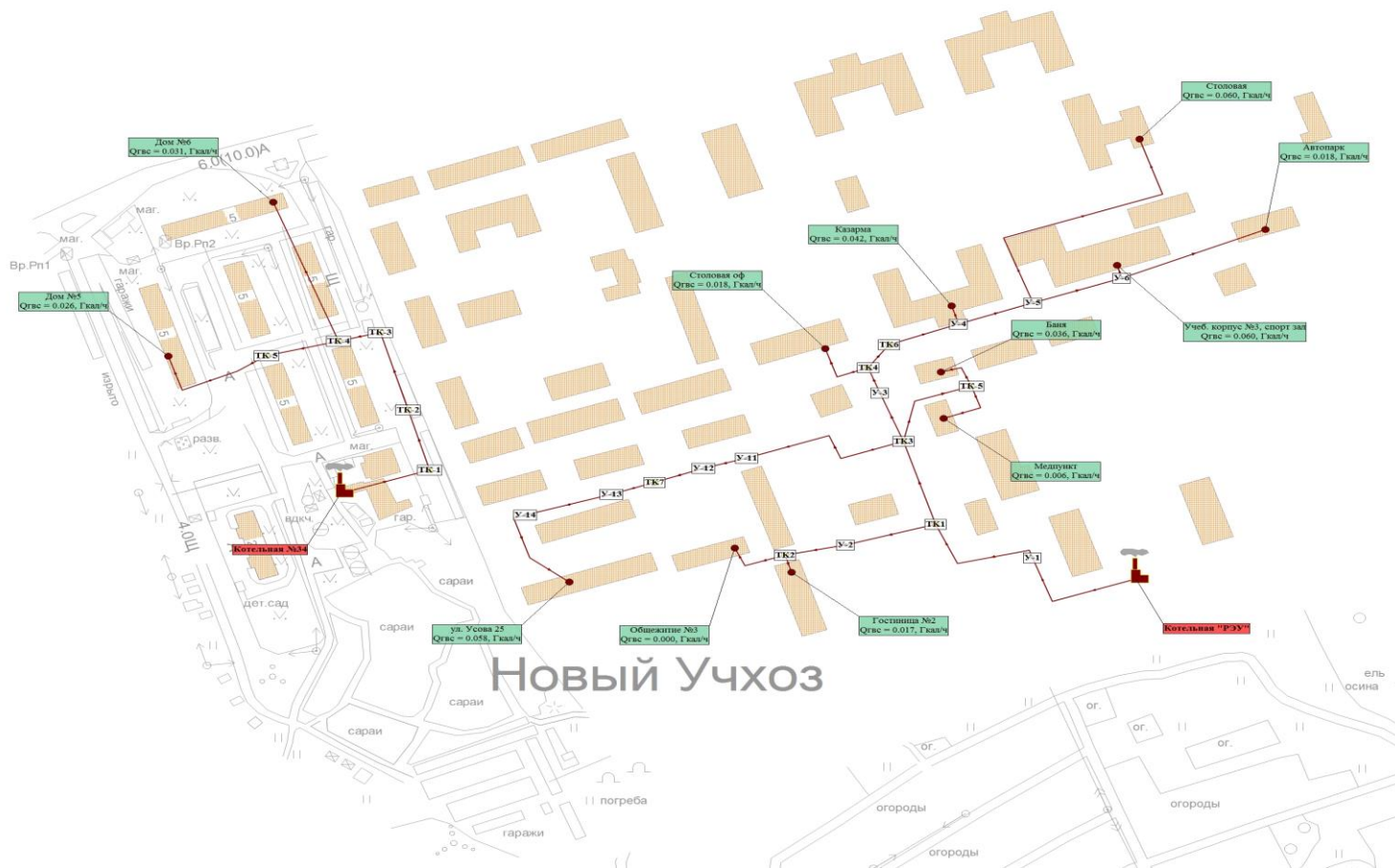
Рисунок 1.10. Схема тепловых сетей котельной АО «ГУ ЖКХ» пос. Новый Учхоз (контур ГВС)
