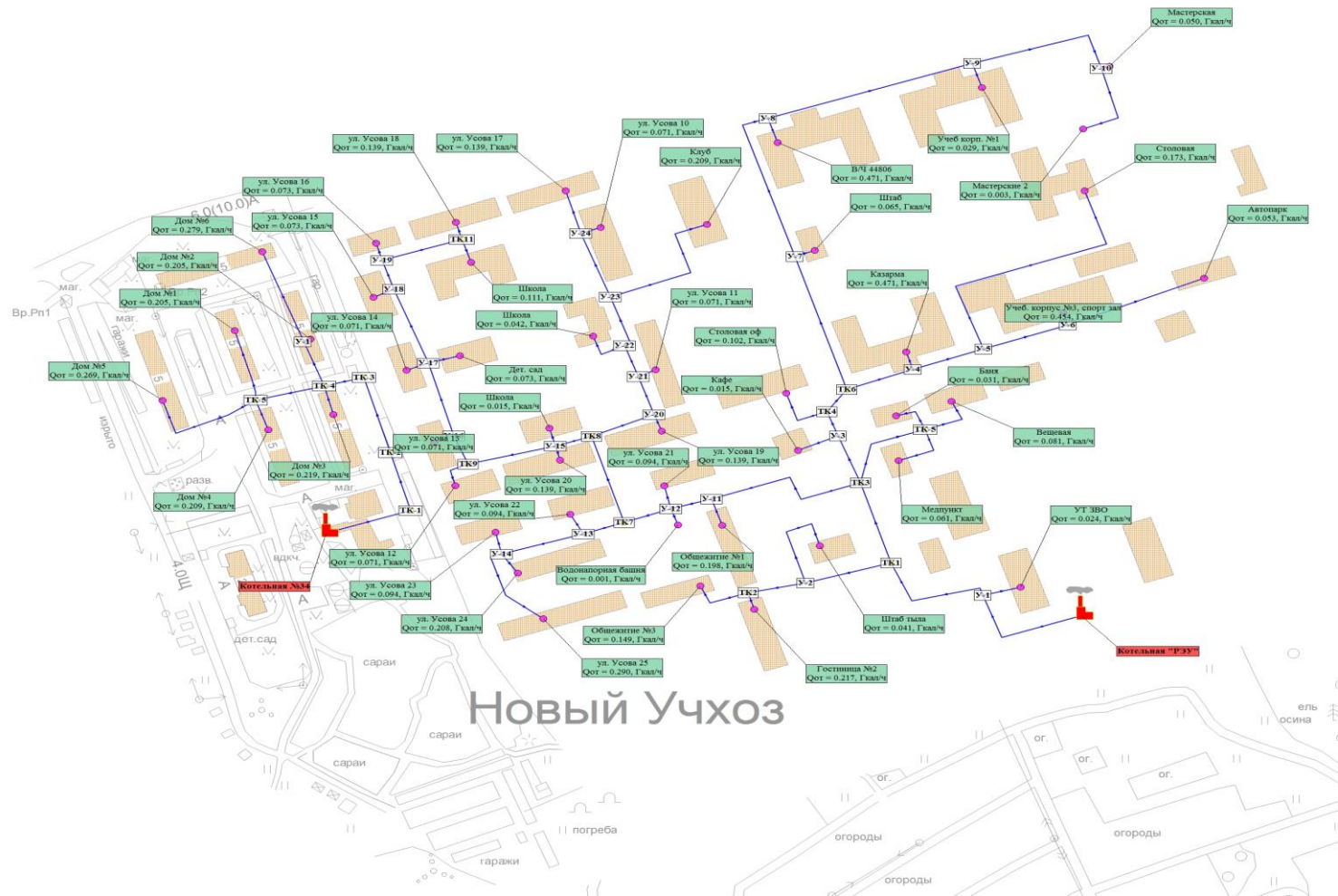
Рисунок 1.9. Схема тепловых сетей котельной АО «ГУ ЖКХ» пос. Новый Учхоз (контур отопления)
